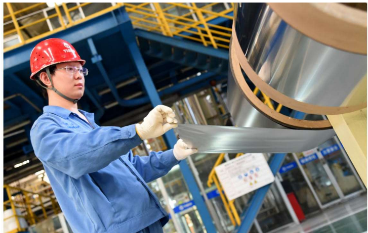
图 21 超平、超薄、超硬、超光滑的宽幅精密带钢箔材 (0.02mm) “手撕钢”成功下线
