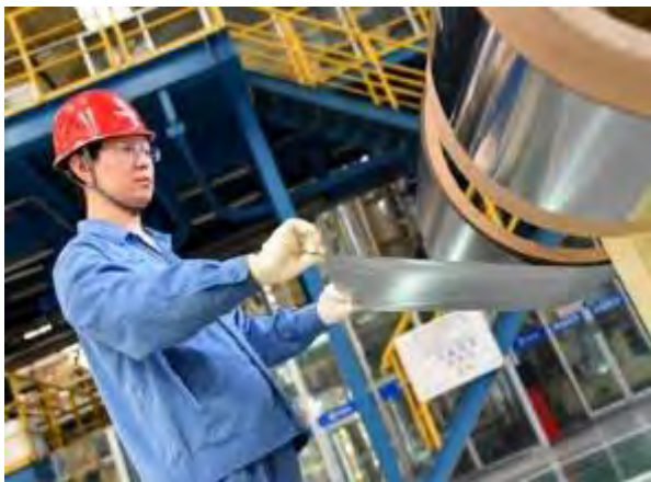
图 28 超平、超薄、超硬的宽幅精密带钢箔材 (0.02mm)“手撕钢”
