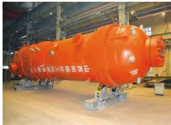
图 29 水煤浆水冷壁直连半废锅合成气/蒸汽联产 气化炉
