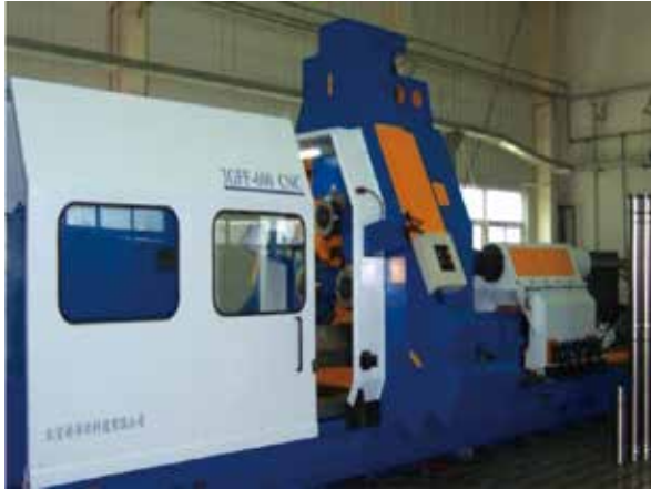
三旋轮强力旋压机及产品
